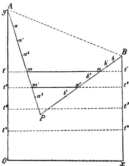
Liegt der Schnittpunkt der Geraden, der natürlich eine Schmelztemperatur darstellt, oberhalb der umgebenden Temperatur, so stellen für uns die Gemische der Körper  $A$  und  $B$  nur feste Gemische; fällt dagegen der Kreuzungspunkt der Geraden mit der atmosphärischen Temperatur zusammen, so wird sich nur eine von ganz genau bestimmter Zusammensetzung, flüssige Mischung
