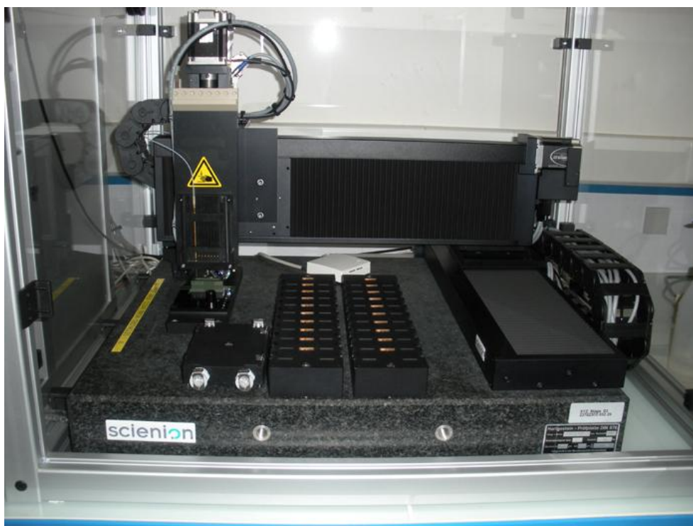
Ryc.8. Urządzenie dozujące mikrokrople typu S3 sciFLEXARRAYER.
