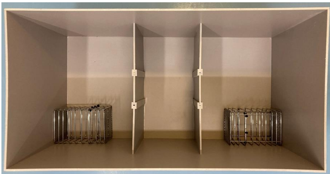
Rycina 8. Boks wykorzystywany do trójkomorowego testu socjalizacji. W środku umieszczono metalowe klatki na wizytatorów. W środkowej komorze widoczne zamknięte przejścia.
