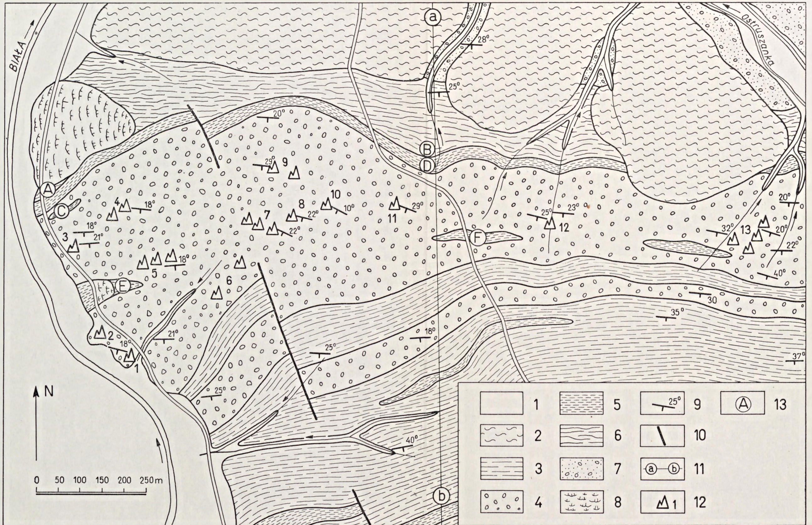
Ryc. 2. Mapa geologiczna okolic Ciężkowic (wg Koszarskiego 1963 i obserwacji własnych): 1 — ropy, piaski i żwiry aluwialne, 2 — gliny aluwialne i deluwialne, 3 — łupki zielone i piaskowce warstw hieroglifowych, 4 — piaskowce i zlepienie ciężkowickie, 5 — łupki pstre i czerwone, 6 — łupki istebniańskie górne, 7 — piaskowce i zlepienie istebniańskie, 8 — osuwisko, 9 — bieg i upad warstwy, 10 — przebieg uskoku, 11 — linia przekroju geologicznego, 12 — występowanie form skalnych i ich numeracja (1—13), 13 — miejsca pobrania prób (A-F)
