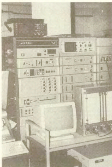
Rys. 4.11 Elementy zestawu pomiarowo - rejestrującego : konsola sterownicza maszyny Instron, oscyloskop Phillips, rejestrator analogowy XY.
