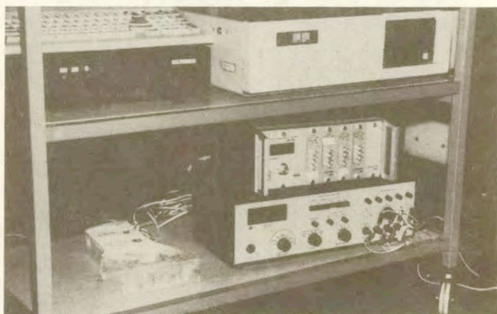
Rys.4.10. Elementy zestawu pomiarowo-rejestrującego :rejestратор cyfrowy "Combo", komputer IBM PC/XT, mostek Brüel & Kjaer 1526, generator Peltron MPL 104 oraz fragment próbki z naklejonymi tensometrami-świadkami.
