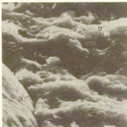
Rys.2.1 Mikroskopowy obraz struktury betonu żwirowego w powiększeniu 2000 razy (PROKOPSKI (1990)).
