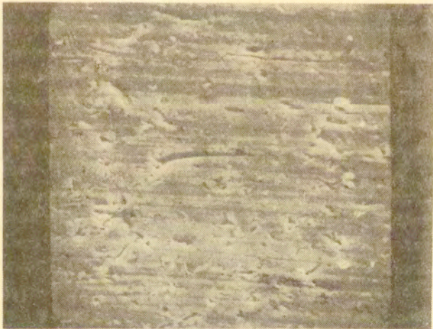
Rys. 47 . Stan powierzchni łożyska po 400 h eksploatacji.
