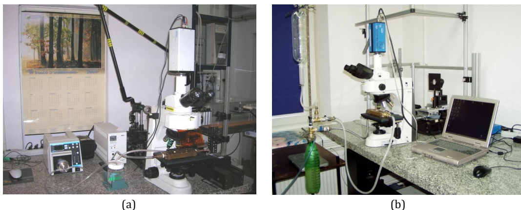
Rys. 4.4. Stanowisko pomiarowe techniką \mu PIV: a – układ z wymuszaniem przepływu za pomocą pompy zębatej, b – układ z wymuszaniem przepływu przez specjalnie zbudowany układ ciśnieniowy
