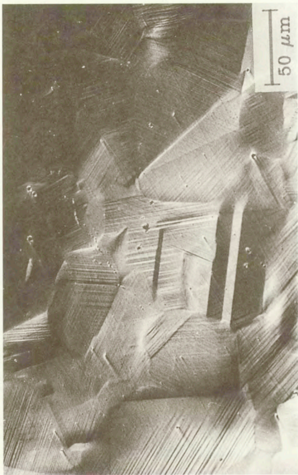
Rys. 28. Mezostruktura powierzchni próbki o odkształceniu, \varepsilon = 0.0106 .
