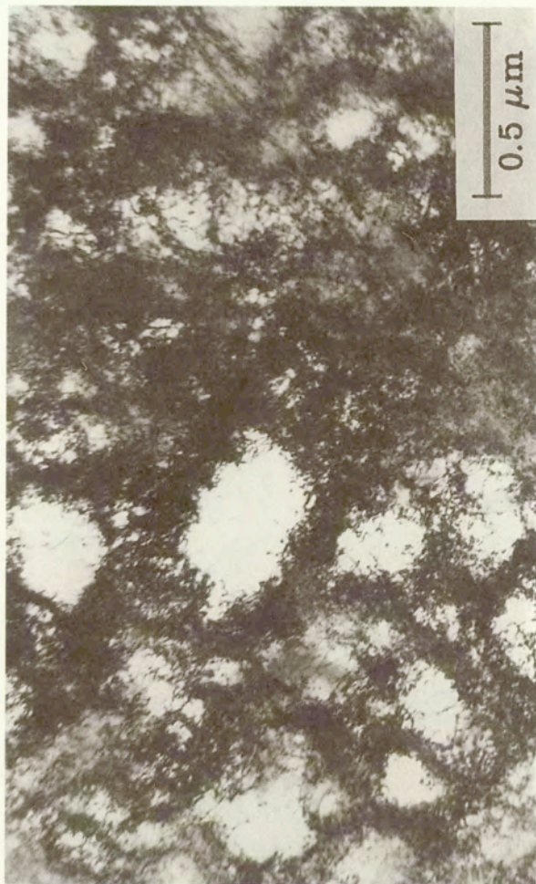
Rys. 25a. Komórkowa struktura dyslokacyjna w próbkach drobnoziarnistych, \varepsilon = 0.25 .
