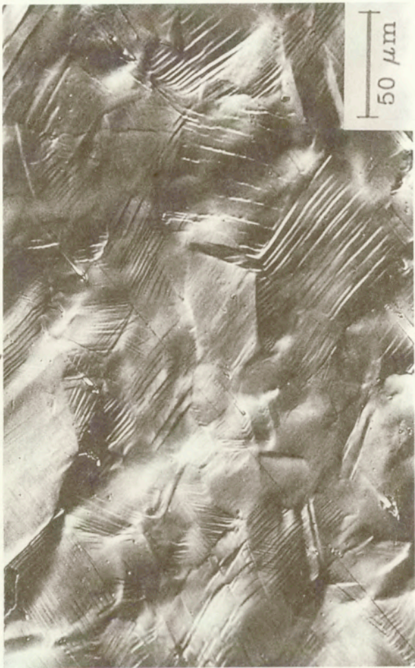
Rys. 31. Mezostruktura powierzchni próbki o odkształceniu, \epsilon = 0.20 . Widoczny jest front Ludersa.
