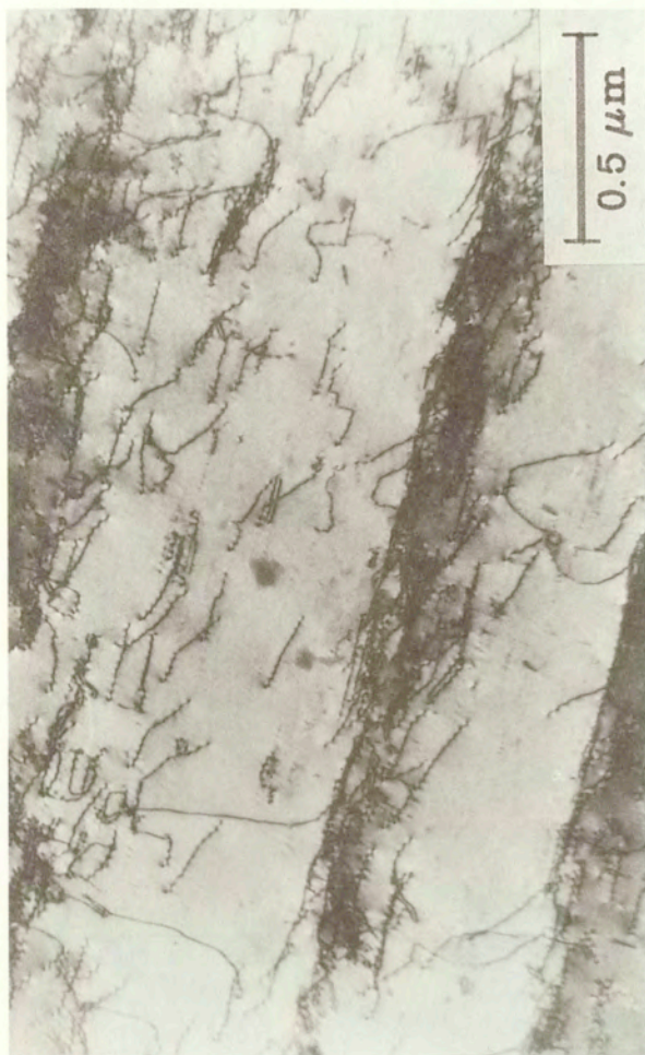
Rys. 24d. Obraz mikrostruktury próbek gruboziarnistych, odpowiadającej zmniejszeniu się zdolności magazynowania energii, \epsilon = 0.095 . Struktura pasmowa.
