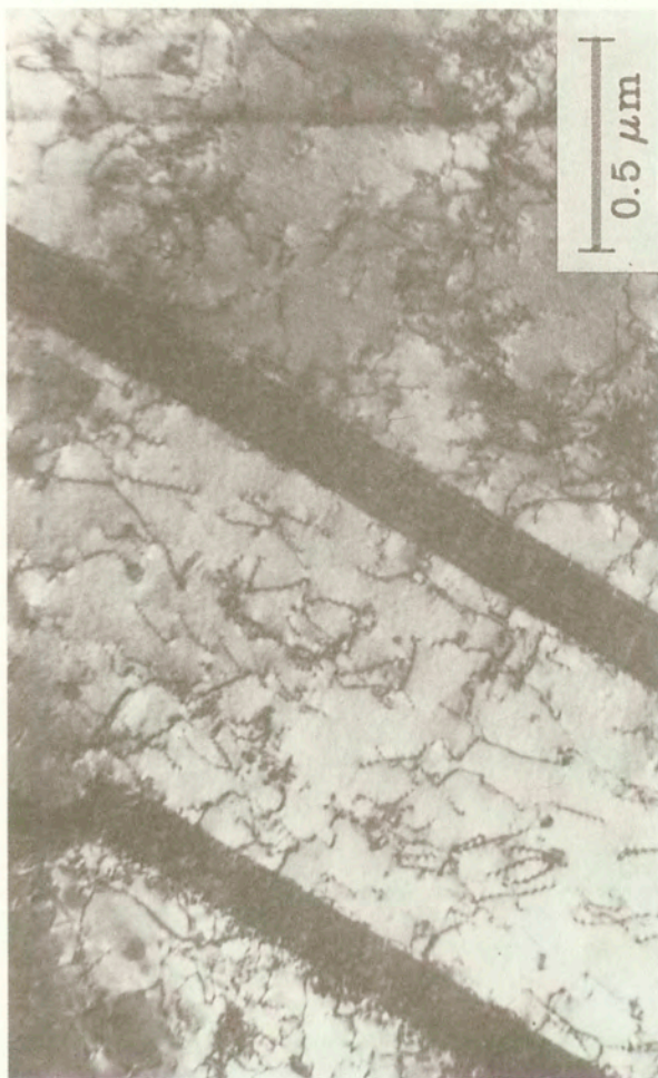
Rys. 23a. Obraz mikrostruktury próbek drobnoziarnistych, odpowiadającej maksimum d\epsilon/d\epsilon , \epsilon = 0.028 . Równomierne rozmieszczenie dyslokacji w granicach 1 w osnowie ziaren.
