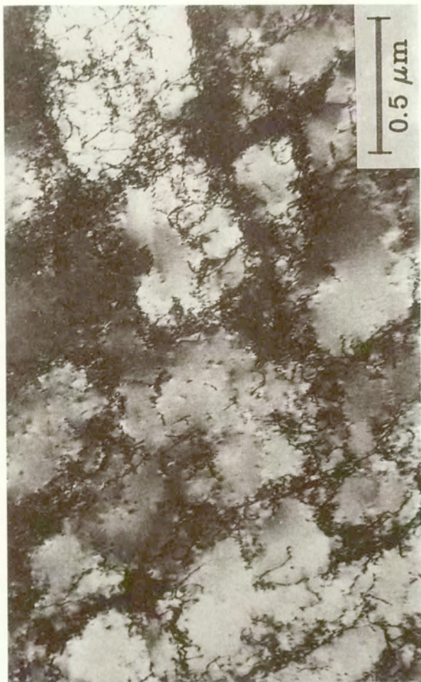
Rys. 25b. Komórkowa struktura dyslokacyjna w próbkach gruboziarnistych, \epsilon = 0.25 .
