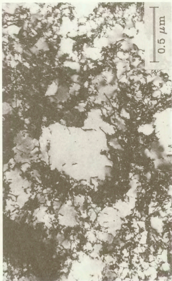
Rys. 24a. Obraz mikrostruktury próbek drobnoziarnistych, odpowiadającej zmniejszaniu się zdolności magazynowania energii, \epsilon = 0.105 .
