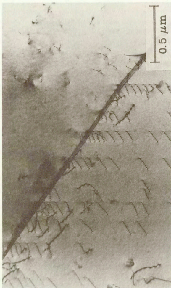
Rys. 22a. Obraz mikrostruktury próbek drobnoziarnistych \epsilon = 0.013 . Spiętrzenia dyslokacji w pobliżu granicy przypadkowej.
