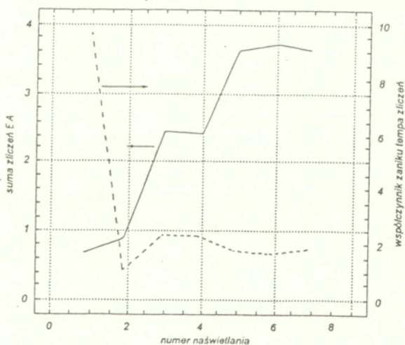
Rys. 36. Zależność sumy zliczeń EA i współczynnika zaniku tempa zliczeń EA w funkcji ilości naświetleń wiązką promieniowania laserowego - w próbce z blachy kwasoodpornej
