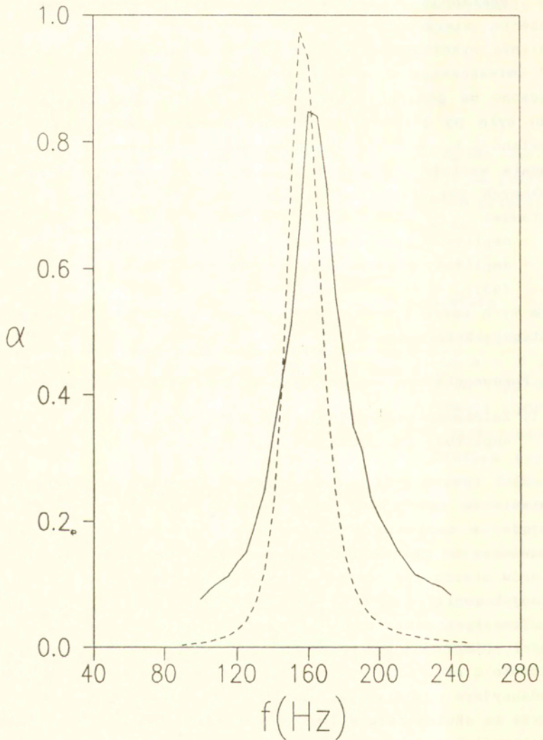
Rys. 2. Współczynnik pochłaniania \alpha rezonatora w funkcji częstotliwości f . Promień otworu b = 1.5 mm, amplituda fali padającej P_0 = 0.16 Pa. Dane eksperymentalne (—), wyniki obliczeń (----).
