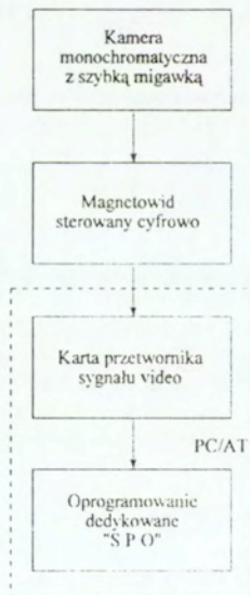
Rys. 4.2. System wizualizacji, gromadzenia i obróbki cyfrowej danych
