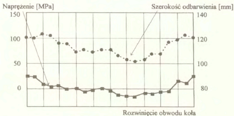
Rys. 135. Obwodowe rozkłady obwodowych naprężeń w powierzchniowej warstwie materiału na wewnętrznej powierzchni wieńca i szerokości odbarwionego pasa. Koło poddane nagrzewaniu z mocą 38 kW.
