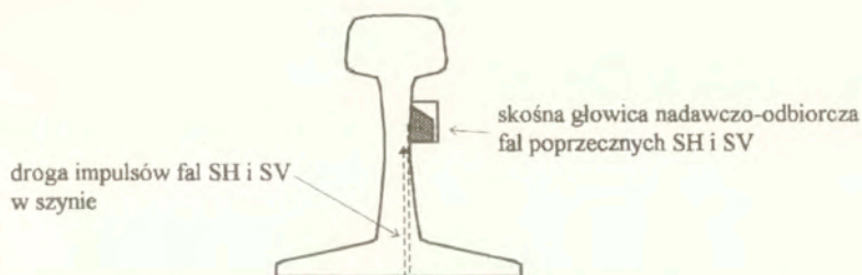
Rys. 101. Położenia głowic i drogi impulsów fal SH i SV w szynie. (Pomiar dwójłomności akustycznej z ominięciem głowki szyny)
