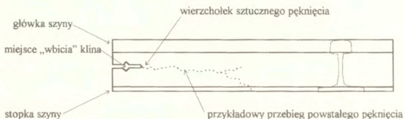
Rys. 83. Schemat oceny naprężeń własnych techniką „whomper test”.
