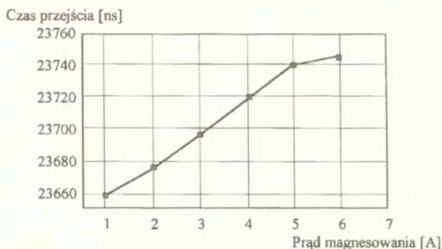
Rys. 60. Zależność czasu przejścia podłużnej fali podpowierzchniowej zmierzona układem różnicowym (nadajnik piezoelektryczny, dwa odbiorniki EMAT z elektromagnesami) od prądu magnesowania.
