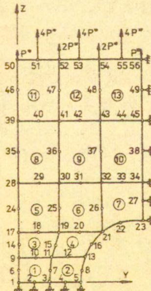
Rys 3. Dyskretyzacja i obciążenia węzłowe ( P^* = P_b/36 )
