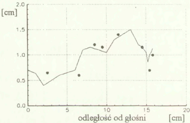
Rys. 8.12 Wynik modelowania funkcji powierzchni przekroju (u góry) dla samogłoski /a/. U dołu podano odpowiadający jej przekrój wzdłużny toru. Kropkami zaznaczono wymiary poprzeczne toru głosowego podane w pracy [BOLLA&FÖLDI,1987].
