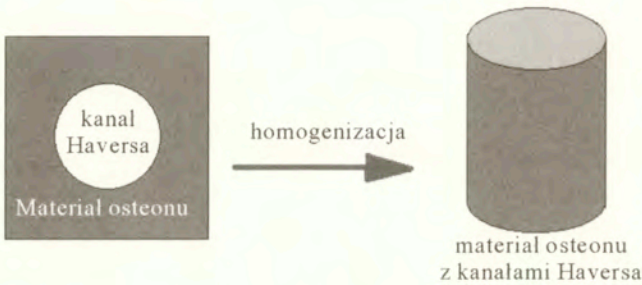
Rysunek 7.14. Homogenizacja materiału osteonu z uwzględnieniem kanałów Haversa
