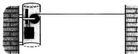
Rys. 5.4 Schemat ekstensometru linowego
