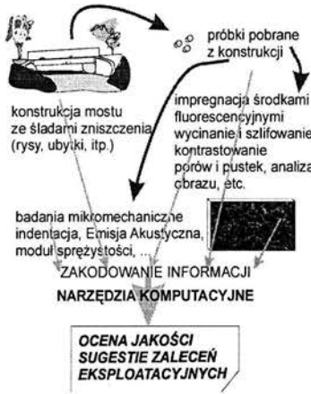
Rys. 1. Schemat automatycznej oceny stanu mostu
