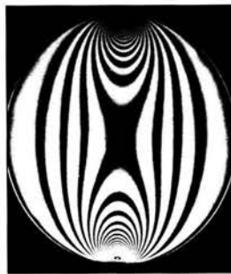
Rys. 4. Pierwotnie izotropowa przezroczysta płytka kołowa staje się anizotropową po obciążeniu
