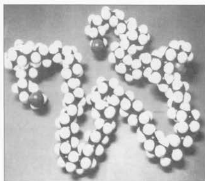
Rys. 4. Model molekularny polietylenu. Kule oznaczają atomy (węgla i wodoru)
