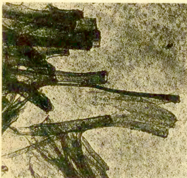
Rys.5. Fragment zdjęcia cztery, powiększenie 70 000. Widać strukturę włókien /puste w środku rurki!/.
