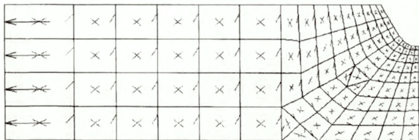
Rys. 5.4 Siatka podziału na elementy.
