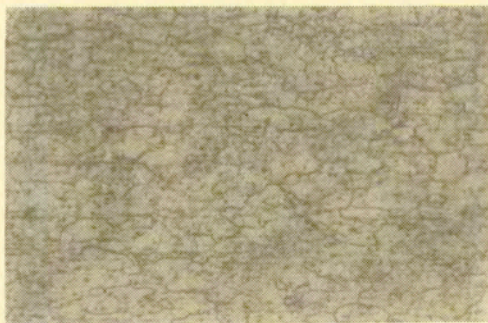
Rys.5.15. Kształt ziaren po wyżarzaniu
