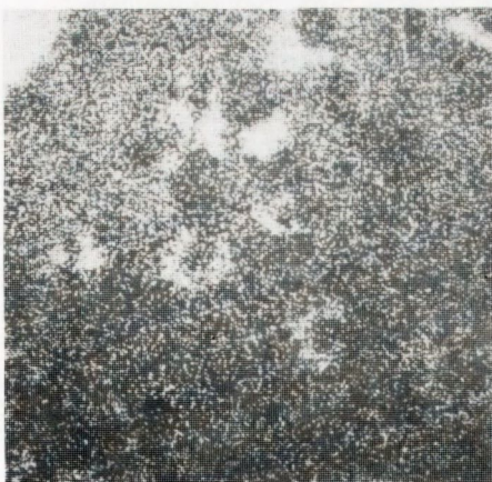
Rys. 13. Rozkład powierzchniowy Ag. Powiększenie 600x
