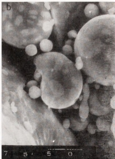
Rys. 4. Charakterystyczne rozkłady faz \alpha i \beta na powierzchniach cząstek proszku LC63 w klasie ziarnowej (-75, +45) [ \mu\text{m} ]. Faza \beta - ciemna. Pow. 5000 x a) typowy rozkład faz \alpha i \beta , b) rozkład faz \alpha i \beta w cząstkach aglomeratów
