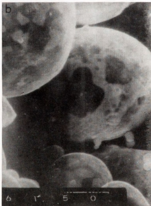
Rys. 5. Charakterystyczny rozkład faz \alpha i \beta na powierzchniach cząstek proszku LC63 w klasie ziarnowej (-25) [ \mu\text{m} ]. Faza \beta - ciemna. a) Pow. 2000x, b) Pow. 5000x
