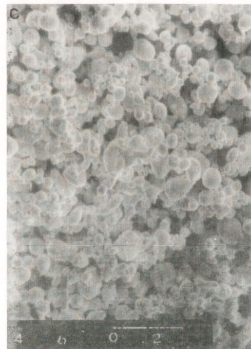
Rys. 3. Typowy kształt cząstek proszku LC63 w klasach ziarnowych [ \mu\text{m} ]:
