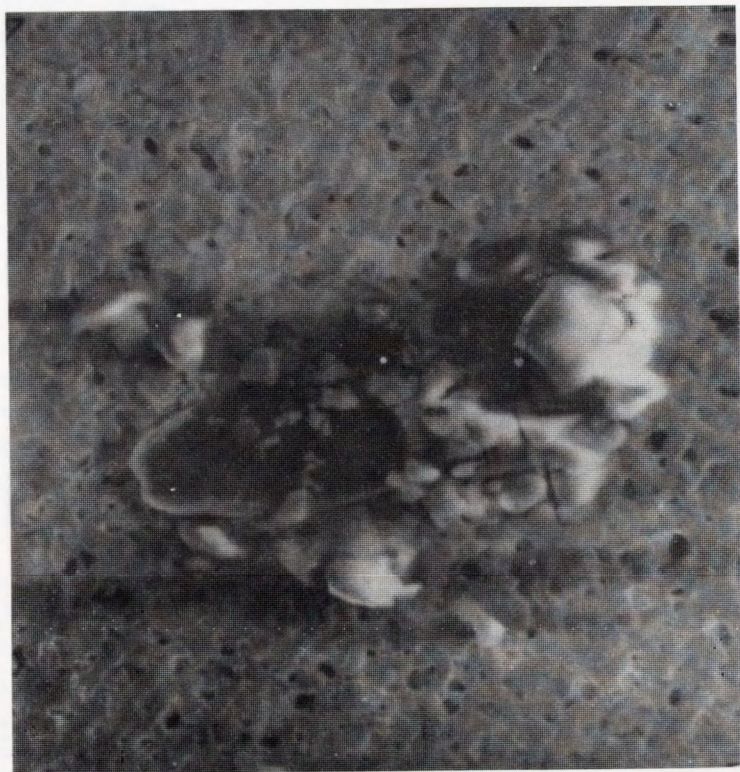
c) po zerwaniu drutu AlSi (1%) \phi 20 \mu\text{m} po starzeniu 48 h w 423 K,
