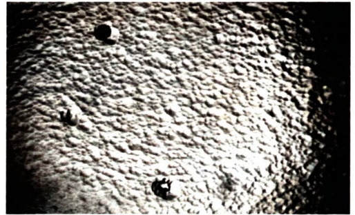
Rys. 4. Fotografia obszaru z rozwiniętą powierzchnią na płytce z procesu nr 427. Fig. 4. Micrograph of the top layer surface without pyramids (layer no. 427).
