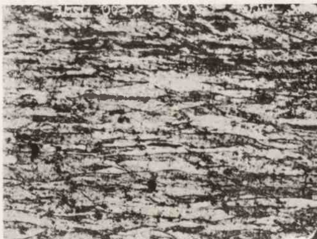
Rys. 3. Struktura stali na maski cieniowe (M3), przekrój wzdłużny (x100)
