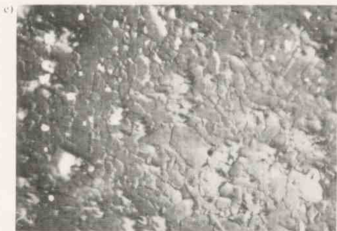
Rys. 8. Zdjęcia powierzchni trawionych zglądów mieszanin tlenku glinowego z \text{Cr}_2\text{O}_3 wypalanych w temperaturze 1670^\circ\text{C} (pow. 600x)
