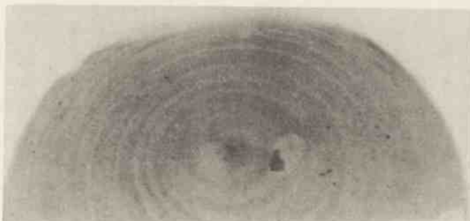
Rys. 7. Autoradiogram rozmieszczenia chromu ^{51}\text{Cr} w rubinie /przekrój poprzeczny - pow. 5x/
