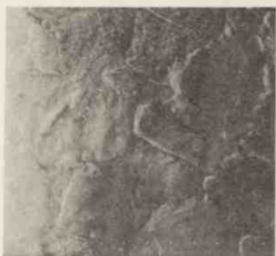
Rys. 4-d wyprowadzenie TO116f po 21 dobach narażenia na gorącą wilgoć stałą, T=40^{\circ}\text{C} /500x/
