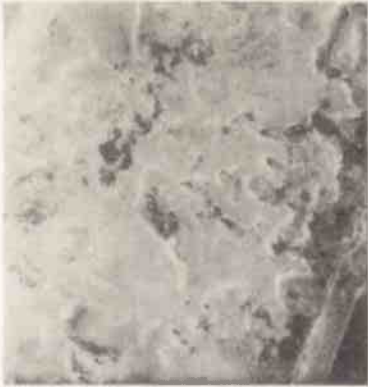
Rys. 5-a, b TO 116f po dwóch dobach narażenia na słoną mgłę a - powiększenie 50x b - powiększenie 500x
