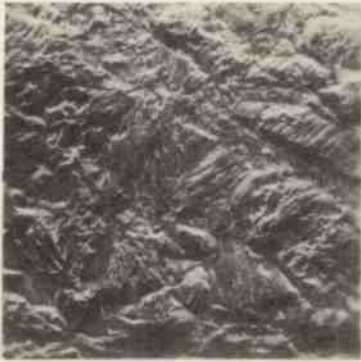
Rys. 5-f. Wyprowadzenia obudowy mikroukładu hybridowego po narażeniu na słońc mgłę przez 4 doby /460x/
