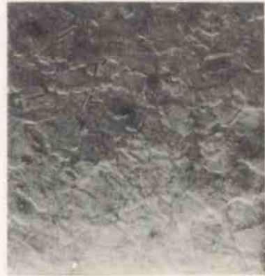
Rys. 5-c - TO 116f po dwóch dobach narażenia na słoną mgłę /150x/
