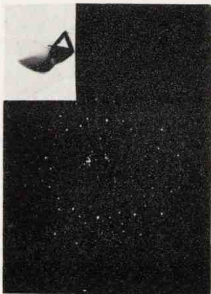
Rys. 4. Błędy ułożenia związane z narostami epitaksjalnymi /31 x/ u góry: pojedynczy defekt /780x/
