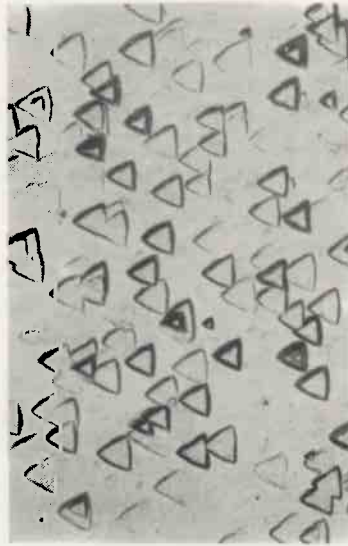
Rys. 5. - Płaskie jamki odpowiadające dyslokacjom z atmosferą zanieczyszczeń w Cu
