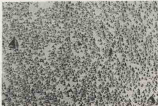
Rys. 9. Jamki w GaP ujawnione bezpośrednio po polerowaniu mechanicznym
