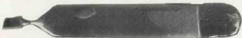
Rys. 1. Monokryształy arsenku galu a - otrzymane metodą Czochralskiego b - otrzymane metodą kierunkowej krystalizacji poziomej
