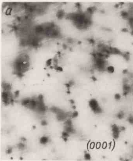
Rys. 4. Wtrącenia w kryształach CdS widziane w świetle przechodzącym w kierunku \langle 0001 \rangle : a/ wtrącenia symetryczne rozpraszające światło, b/ wtrącenia nieregularne /pow. 600x/
