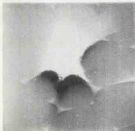
Rys. 28. Obraz spieku molibdenu /I frakcja/ z dodatkiem niklu /II frakcja/ spiekanego przez 3 h w temperaturze 1300°C a - obraz reliefu powierzchni, b - obraz składu chemicznego, c - obraz rozmieszczenia molibdenu, d - obraz rozmieszczenia niklu
