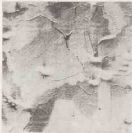
Rys. 28. Obraz spieku molibdenu /I frakcja/ z dodatkiem niklu /II frakcja/ spiekanego przez 3 h w temperaturze 1300°C a - obraz reliefu powierzchni, b - obraz składu chemicznego, c - obraz rozmieszczenia molibdenu, d - obraz rozmieszczenia niklu
