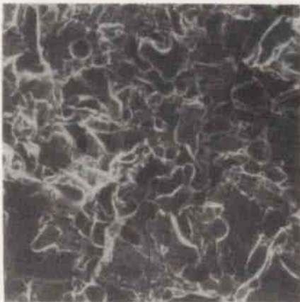
Rys. 19. Obraz przełomu molibdenu /I frakcja/ z dodatkiem niklu /I frakcja/ spiekanego przez 3 h w temperaturze 1900°C /pow. 300x/
