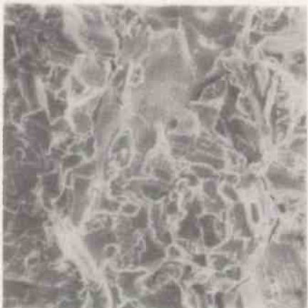
Rys. 20. Obraz przełomu molibdenu /I frakcja/ z dodatkiem niklu /II frakcja/ spiekanego przez 3 h w temperaturze 1900°C /pow. 300x/
