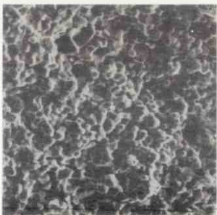
Rys. 11. Obraz przetomu molibdenu /I frakcja/ spiekane go przez 3 h w temperaturze 1000°C /pow. 600x/
