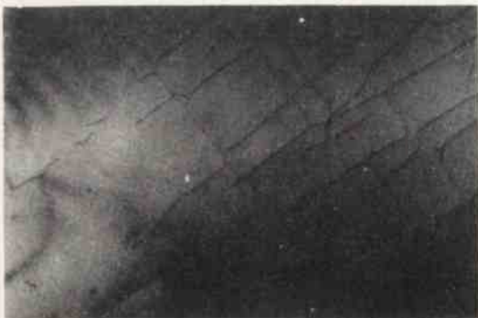
Rys. 5 Obraz dyslokacji niedopasowania leżących na powierzchni rozdziału podłoże – warstwa
