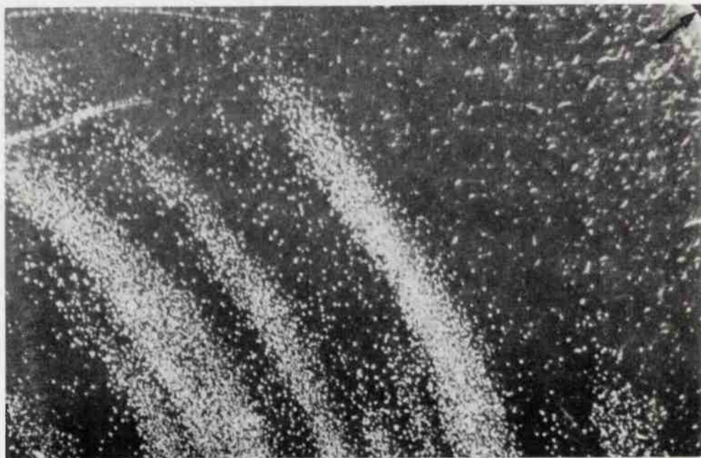
Rys. 11. Topografia Langa fragmentu płytki krzemowej wykonana po dekoracji miedzią. Refleks \bar{1}\bar{1}1 , \text{CuK}\alpha_1 /pow. 15x/
