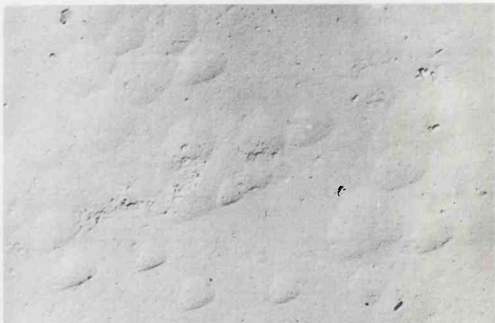
Rys. 4. Elektronoptyczny obraz repliki zdjętej z fragmentu prążka "swirls" /pow. 6400x/
