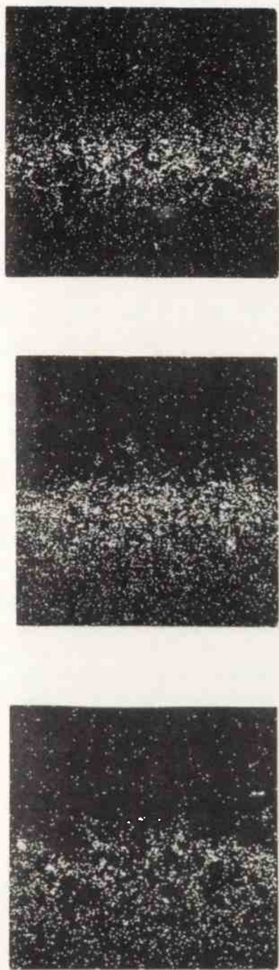
Rys. 13. Rozłożenie Si w złączach z warstwą metaliczną spiekana w następujących warunkach: (a) 1175°C - 15 min, (b) 1235°C - 45 min, (c) 1330°C - 30 min
