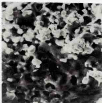
Rys. 30. Przełom rezerwanego złącza od strony ceramiki posiadającego warstwę metaliczną spiekana przez 15 min w temperaturze 1175°C; niszczący moment zginający 0,51 \cdot 10^{-2} kGm
