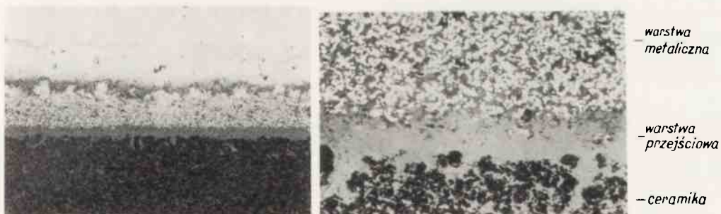
Rys. 5. Struktura złącza ceramika-metal: szlif skośny, parametry spiekania warstwy metalicznej - 1215°C- -15 min, lutowie AgCu28
