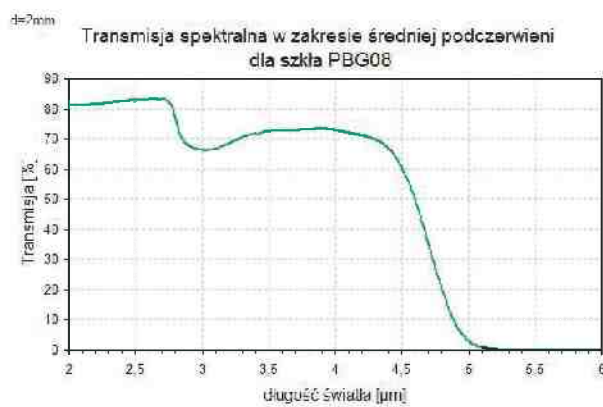
Rys. 3. Transmisja spektralna szkła PBG08 dla próbki o grubości 2 mm w zakresie 300 ÷ 2050 nm oraz 2000 ÷ 6000 nm. Fig. 3. Spectral transmission of PBG08 glass for a 2 mm sample in 300 ÷ 2050 nm and 2000 ÷ 6000 nm.
