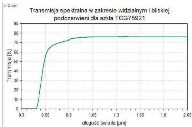
Rys. 4. Transmisja spektralna szkła TCG75921 dla próbki o grubości 2 mm w zakresie 300 \div 2050 nm oraz 2000 \div 8000 nm. Fig. 4. Spectral transmission of TCG75921 glass for a 2 mm sample in 300 \div 2050 nm and 2000 \div 8000 nm.
