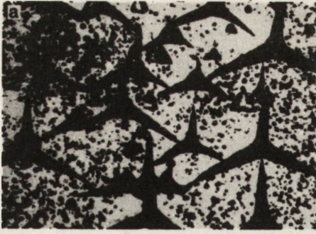
Rys. 1. Obraz defektów w monokrystalicznym krzemie typu /a/ "gwiazdy" i /b/ "drzewa" [4.49]
