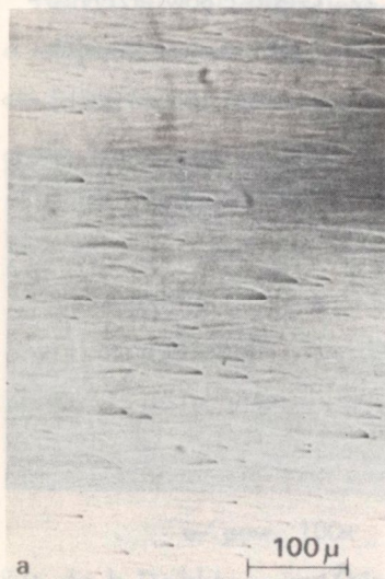
Rys.4. Defekty w kształcie podłużnych wgłębień na powierzchni Si po trawieniu w HCl w temp. 1192°C [10]
