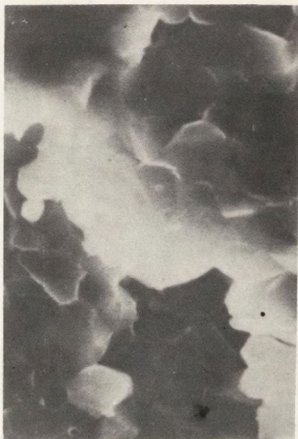
Rys. 19. Przekłom próbki nr 6, serii nr 2, złamanej metodą zginania 4-punktowego; miejsce D /pow. 3000x/
