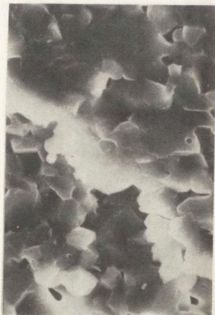
Rys. 18. Przekłom próbki nr 6, serii nr 2, złamanej metodą zginania 4-punktowego; miejsce D /pow. 1800x/
