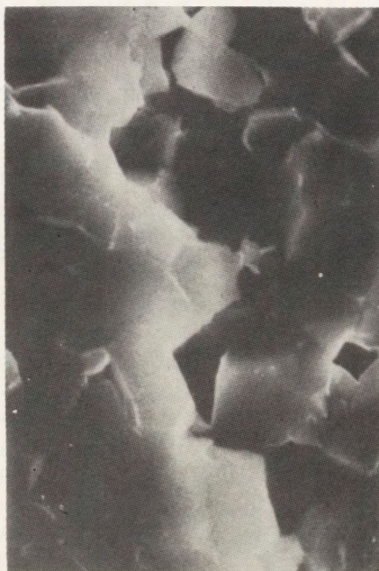
Rys. 15. Przekrój próbki nr 6, serii nr 2, złamanej metodą zginania 3-punktowego; miejsce B /pow. 3000x/
