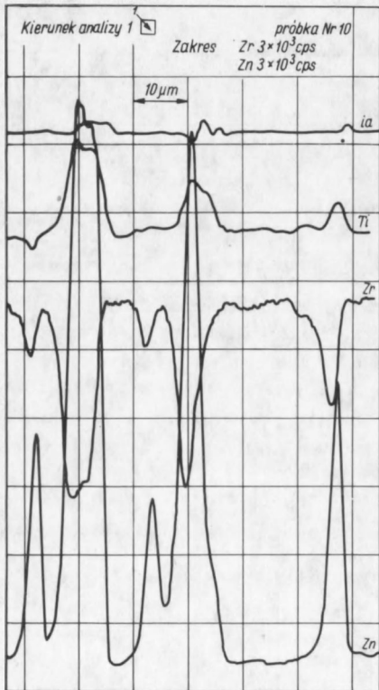
Rys. 46. Rozkład liniowy pierwiastków w próbce nr 10 / d_m = 3,1 \mu\text{m} , 6% molowych ZnO/ spiekanej izotermicznie przez 1 h w temperaturze 1400^\circ\text{C}
