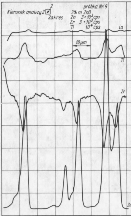
Rys. 45. Rozkład liniowy pierwiastków w próbce nr 9 / d_m = 3,1 \mu\text{m} , 3% molowych ZnO/ spiekanej izotermicznie w temperaturze 1400^\circ\text{C} przez 1 h /zdjęcie rys. nr 43/
