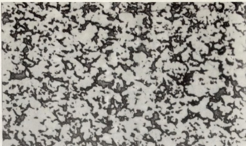
Fot. 1. Struktura kompozytu WCu30 produkcji firmy Doduco z RFN, stosowanego jako materiał stykowy. Faza jasna - wolfram, ciemna - miedź. Pow. 500x
