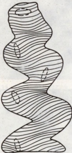
Rys. 62. Zmiana kształtu frontu krystalizacji na osiowym przekroju kryształu. Linią przerywaną zaznaczono obszary o wyraźnie zwiększonej gęstości dyslokacji
