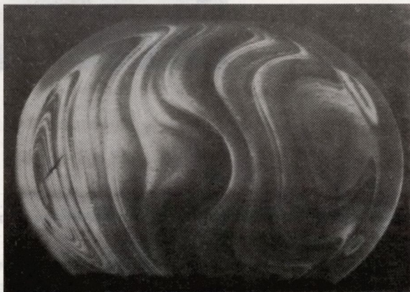
Rys. 17. Topogram płytki 40. Widoczne wtrącenia tlenowe
