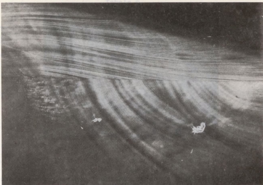
Rys. 28. Topogram dwóch odsłoniętych płaszczyzn kryształu IV (111) i (110) w odbiciu 808
