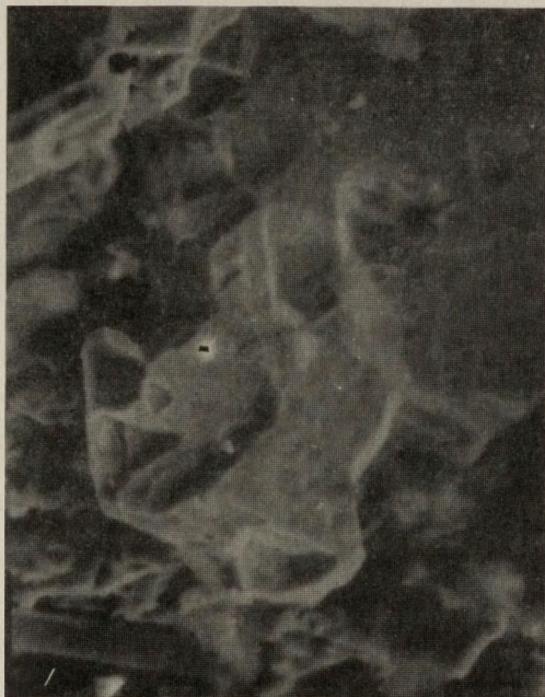
Rys. 10. Polikryształ blokowy z wykształconymi fragmentarycznie dwiema ścianami ośmiościanu oraz relikdami budowy wstęgowej. SEM. Pow. 180x
