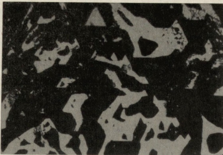
Rys. 16. Powierzchnie polikryształu diamentu szkieletowego typu łuskowego. Obszary białe - diament, czarne - próżnie międzyziarnowe. Światło odbite. Pow. 100x
