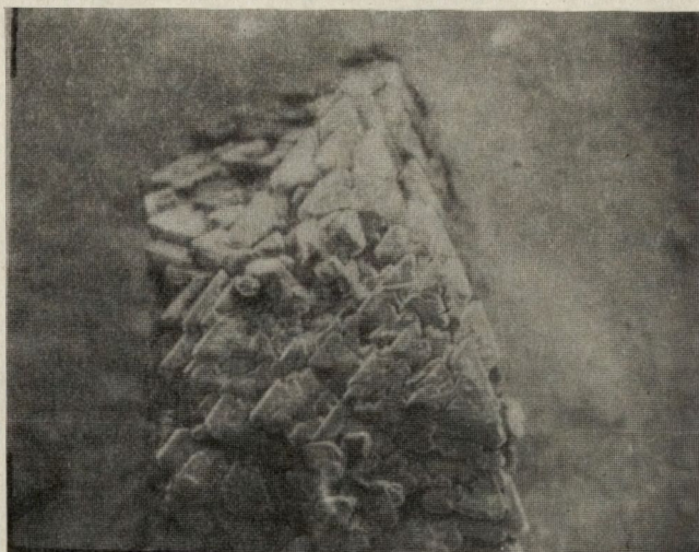
Rys. 12. Polikryształ łuskowy. SEM. Pow. 60x
