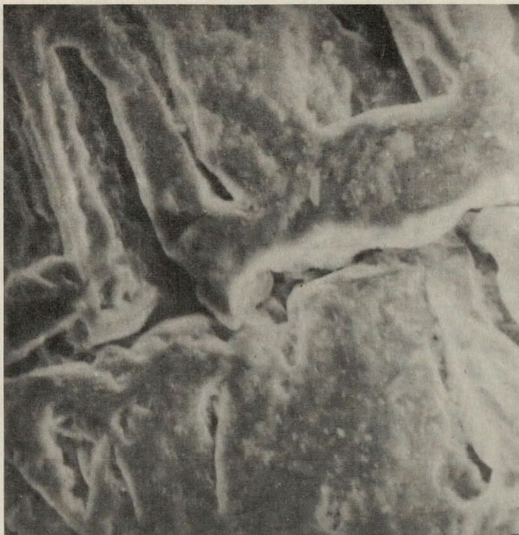
Rys. 5. Ten sam polikryształ - w dolnej części obrazu widoczne płaszczyzny powstałe z rozrostu wstęg materii diamentowej; SEM, pow. 1800x
