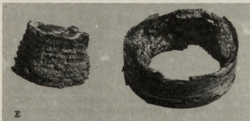
Rys. 15. Fotografie przekroju poprzecznego wyprasek diamentowych syntetyzowanych na kowarze przy ciśnieniu oleju pod tłokiem 795 atm i przy różnych mocach prądu grzania:
