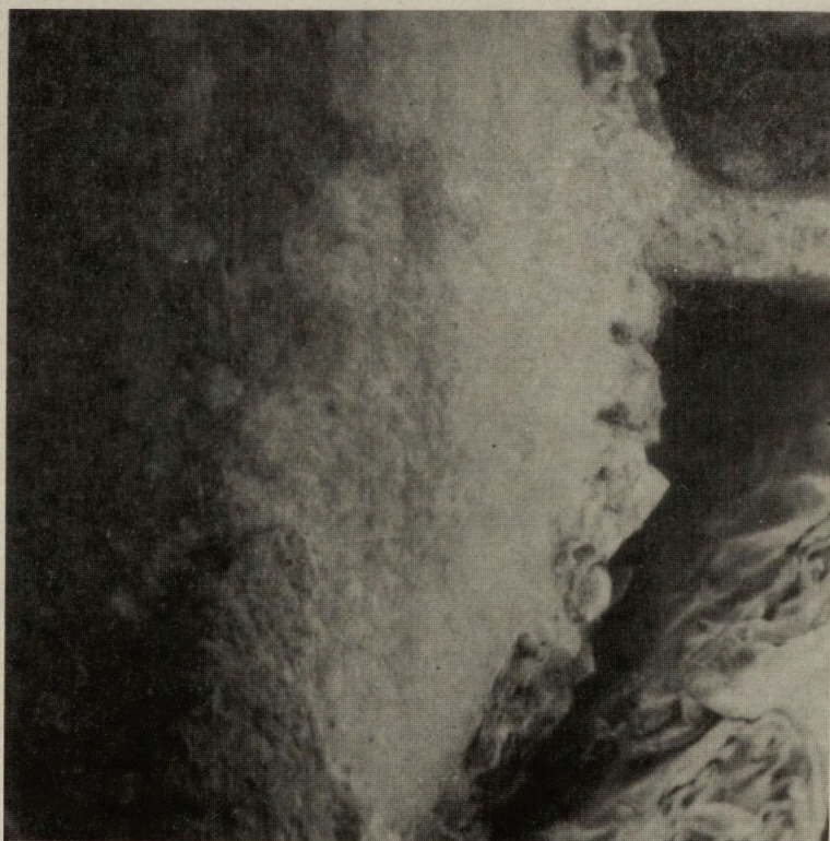
Rys. 4. Zewnętrzna krawędź pierścienia z WC z widoczną /jaśniejszą/ warstwą wzbogaconą w kobalt oraz gruzłowatymi wykwitami Co. Obraz elektronów wtórnych, mikroskop skaningowy; pow. 100x
