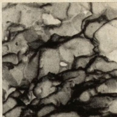
Rys. 4.1. Mikrostruktura tworzywa warystorowego na bazie ZnO a/ powierzchnia polerowana, SEM x 10000 b/ przełom, SEM x 1800
