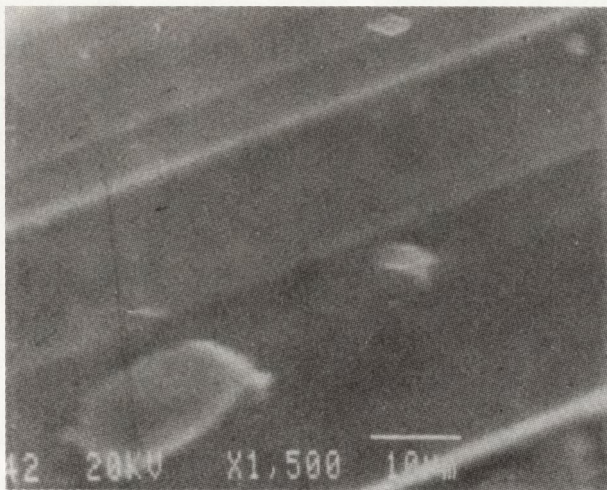
Rys. 15. Struktura węgla szklanego zastosowanego do otrzymania diamentów w niższych ciśnieniach (SEM, Sztokholm University)
