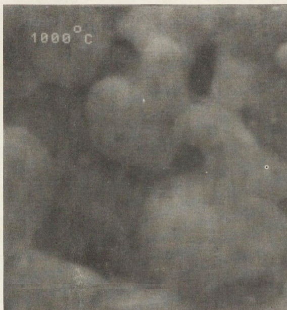
Rys. 19. Proces spiekania warstw z proszku B. Zdjęcia z mikroskopu scanningowego warstw wypalanych w różnej temperaturze, powiększenie 2500 razy:
