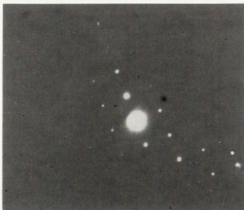
b) dyfraktogram elektronowy pas [001]
