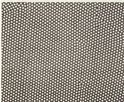
Rys. 4 Przekrój poprzeczny pręcika wielowłóknistego po drugim pocienianiu (włókno elementarne o średnicy ok. 10 \mu\text{m} )
