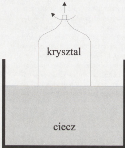
Rys.1. Schemat metody Czochralskiego.
